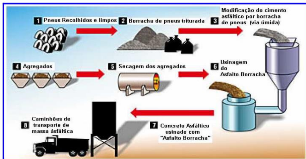
Figura 2 - Esquema de modificação do CAP por borracha de pneu (processo úmido)
